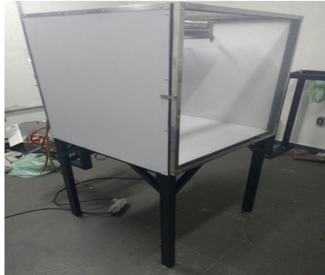
Figura 3 - Estrutura da Estufa com Parede de Acrílico
