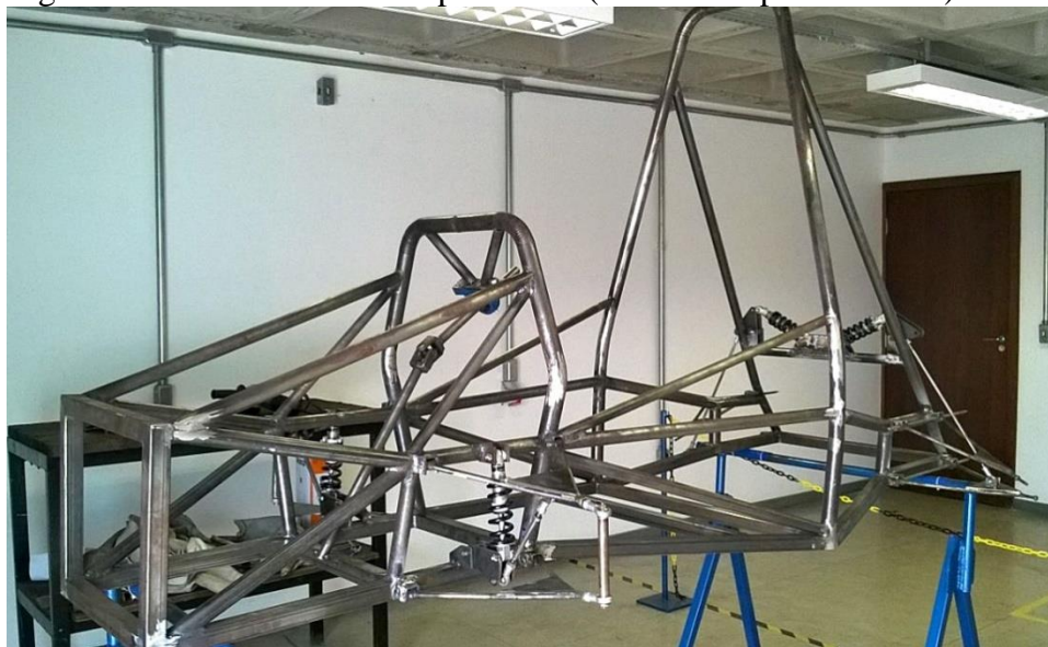
Figura 3 – Estrutura do chassi produzida (Foto tirada pelos autores).
