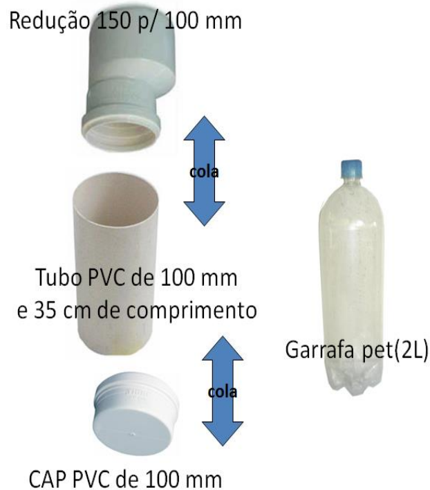
Figura 5 – Instrução de montagem do pluviômetro.
