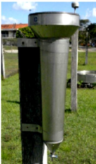
Figura 1- Pluviômetro Ville de Paris.
