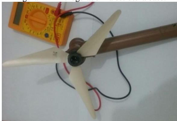
Figura 4 – Microgerador na estrutura base.
