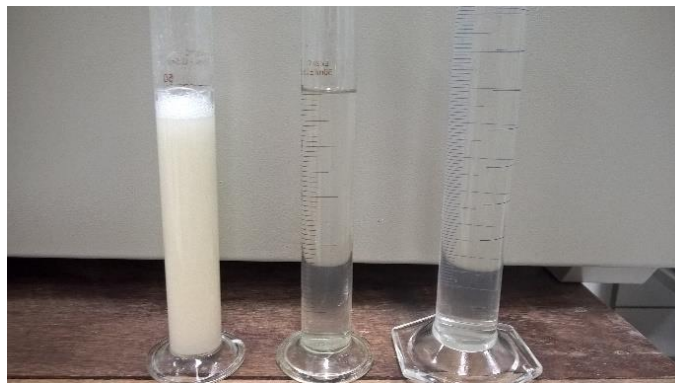
Figura 6. Diferença de turbidez: t_1 = 0\text{min} ; t_2 = 5\text{min} ; t_3 = 10\text{min} , da esquerda para a direita.
