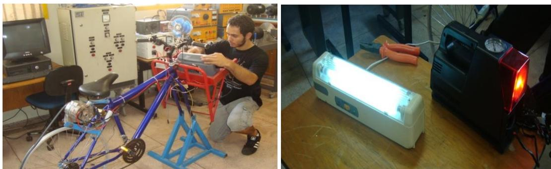
Sendo que o alternador possui seis pares de polos e seis bobinas por enrolamento (fase), a tensão de saída retificada apresenta somente uma leve ondulação. Esta leve ondulação é parcialmente anulada pela bateria que filtra os picos de tensão, comportando-se como um filtro passa-baixo. Para garantir uma boa transferência de carga para a bateria e o funcionamento correto das cargas elétricas conectadas, a tensão à saída do regulador deverá situar-se entre os 13,5 e 14,5 V.
