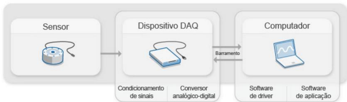
Figura 1 – Elementos básicos de um instrumento virtual
