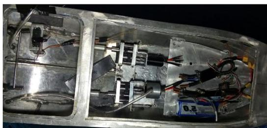
Figura 3 – Sistema elétrico do nautimodelo.
