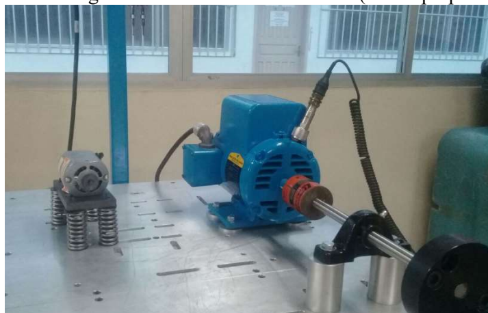
Figura 5 - Experimento de medida de vibração “simpática” transmitido por um gerador de vibrações num motor desligado através de um acelerômetro (Fonte: próprio autor).
