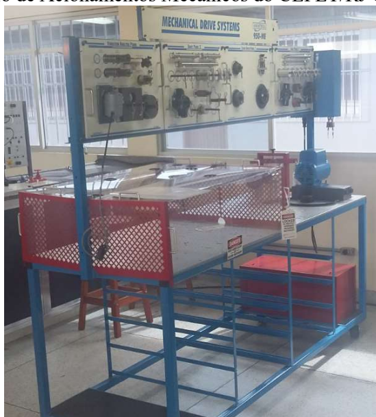
Figura 1 - Bancada de elementos de máquinas Mechanical Drives Learning System 950-ME , localizada no laboratório de Acionamentos Mecânicos do CEFET/RJ Campus Angra dos Reis.
