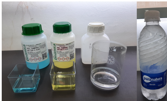
Figura 6 – Soluções tampão (pH 4 e pH 7), água destilada e água mineral utilizadas como referência para a calibração com o pHmetro profissional.
