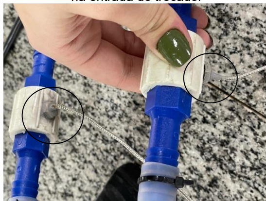
Figura 5 - Dispositivo termopar inserido na entrada do trocador
