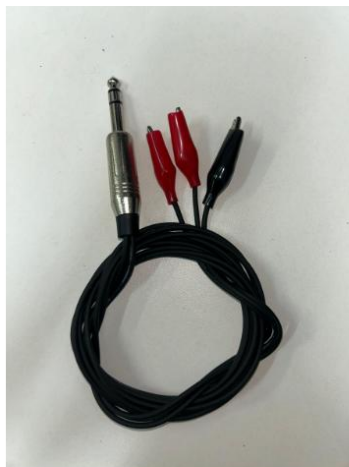
b) Cabo P10 utilizado nos eletrodos
