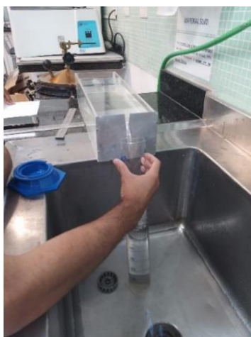
Figura 4 - Aplicação do modelo didático do vertedor triangular de parede delgada.
