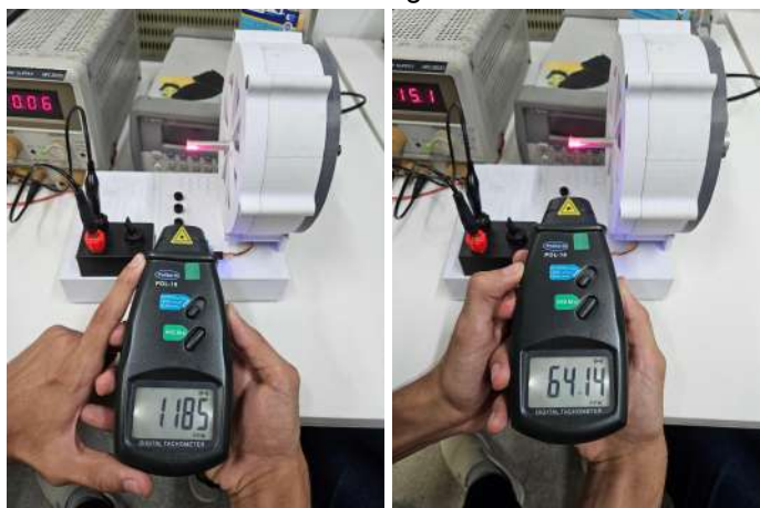
Figura 5 – Medição de velocidade mínima e máxima com tacômetro digital.
