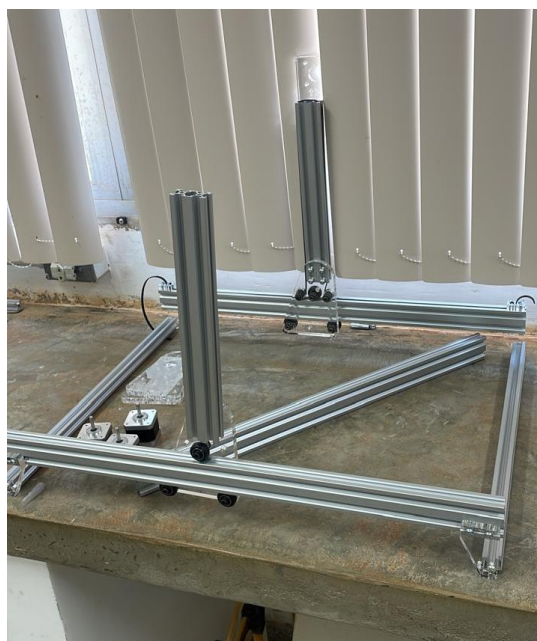
Figura 3 – Montagem da estrutura combinando perfis de alumínio e peças em acrílico.
