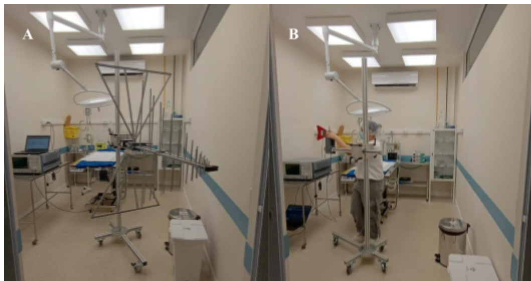
Figura 4 - (A) Direção de medição realizada com a antena LOG. (B) Direção da medição realizada com a antena HORN.
