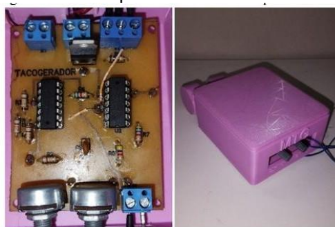
Figura 1 - PCI com o circuito eletrônico e o suporte do MTG
