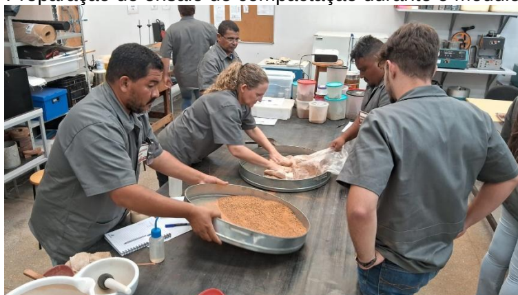
Figura 3: Preparação do ensaio de compactação durante o Módulo 2.
