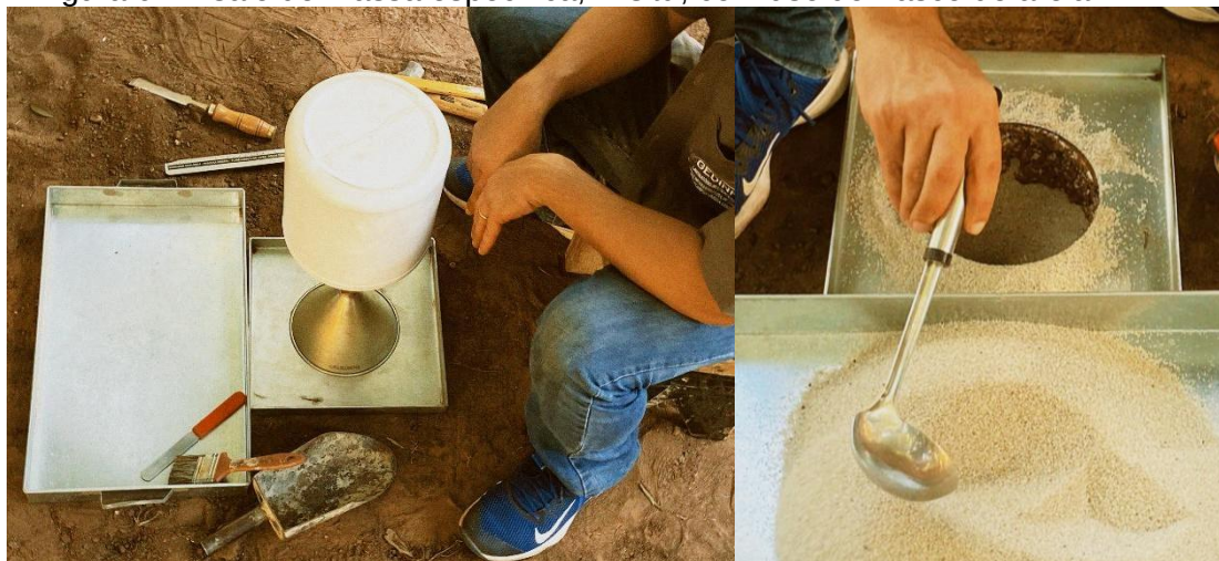
Figura 6: Ensaio de massa específica, in situ , com uso do frasco de areia.
