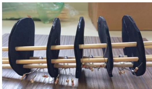
Figura 11 - Montagem estrutural dos LEDs RGB e resistores.
