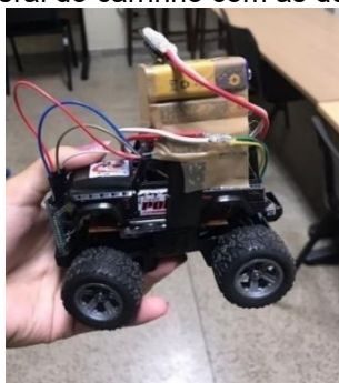
Figura 14 - Vista lateral do carrinho com as duas baterias de 9V.
