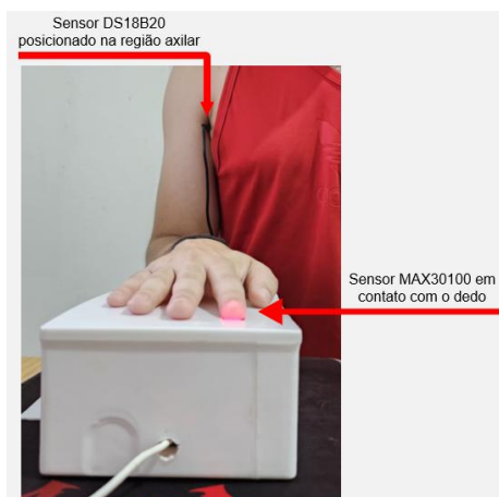
Figura 8 – Protótipo do monitor multiparamétrico em fase de testes com voluntário.
