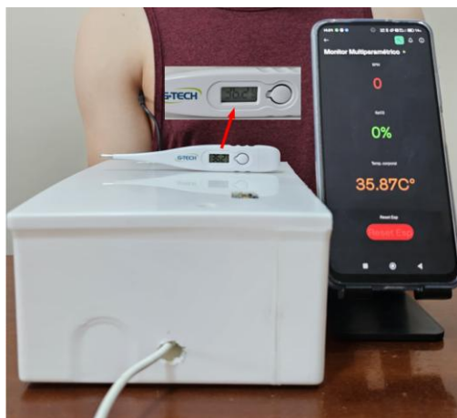
Figura 11 – Comparação termômetro G-TECH com sensor DS18B20
