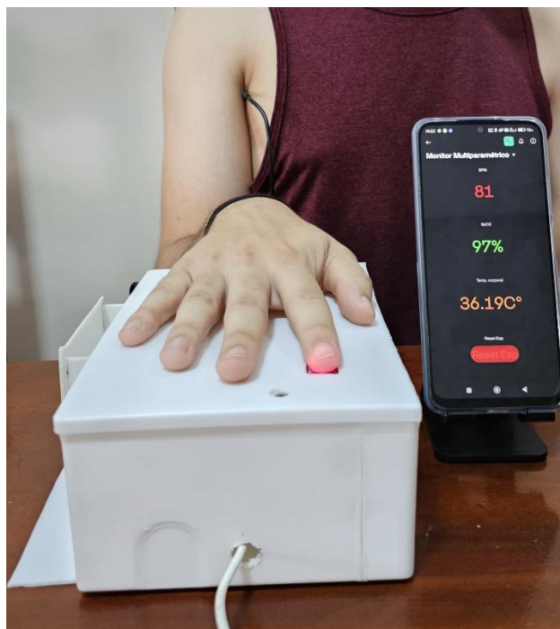
Figura 9 – Protótipo em funcionamento com usuário, exibindo a posição dos sensores e a transmissão dos dados em tempo real para o aplicativo.
