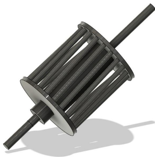
Figura 6: Rotor do motor de (CA) modelado em 3D pelo Fusion 360.
