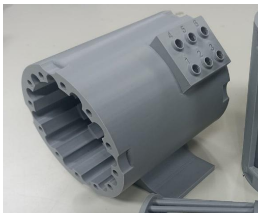
Figura 3: Foto do estator do motor de Corrente Alternada (CA) impresso.
