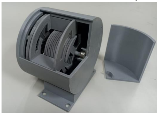
Figura 6: Foto da traseira de um motor impresso em 3D seccionado na lateral.
