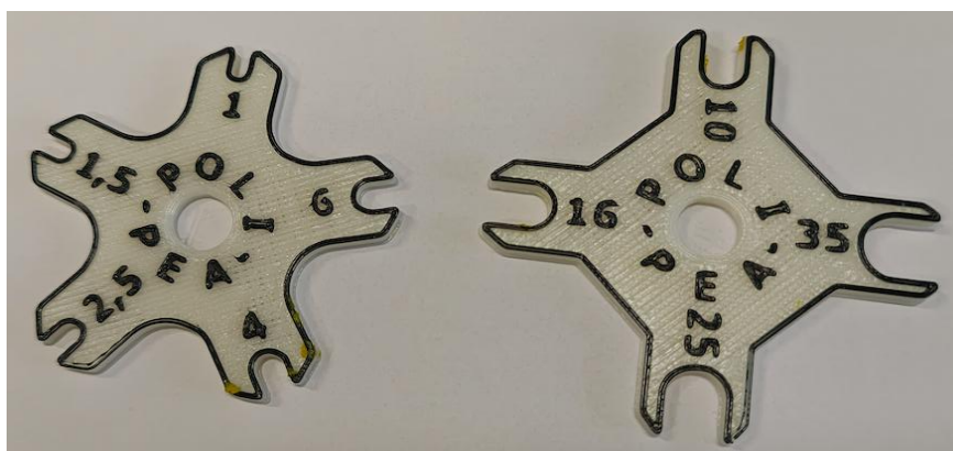
Figura 3 - Foto de um típico medidor de bitola de cabos.
