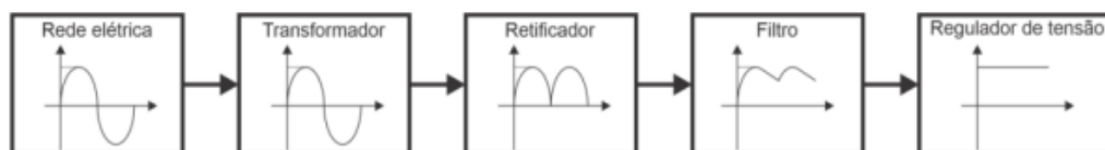
Figura 1 – Diagrama de blocos dos estágios de uma fonte de alimentação linear.
