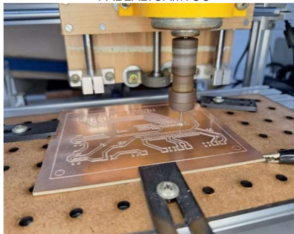
Figura 10: Processo de fabricação da PCB no FABLAB/CAMTUC
