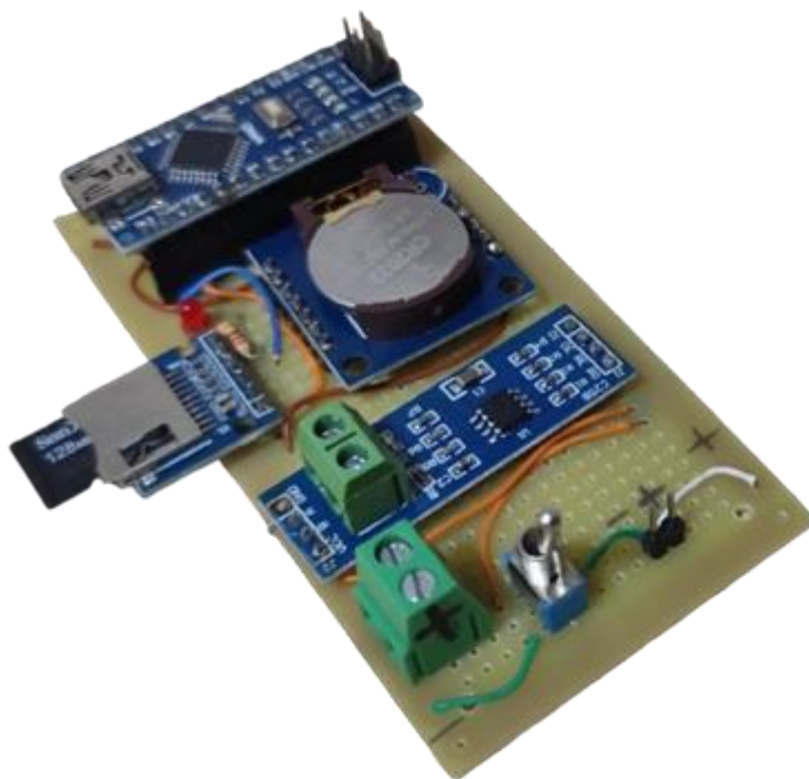
Figura 1– Medidor de radiação solar de baixo custo. Fonte: elaboração própria.
