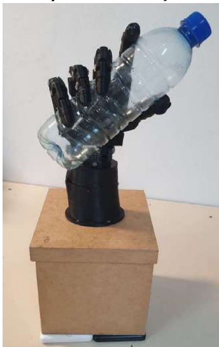
Figura 3 – Estrutura completa do projeto segurando um objeto de demonstração.
