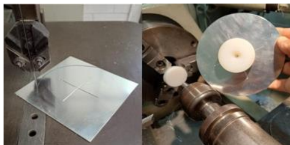
Figura 9 - Etapas de Fabricação da membrana, corte e usinagem
