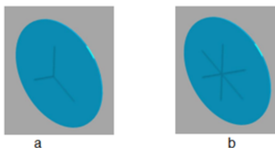
Figura 10. Concepção artística de possíveis geometrias de fragilização, para rompimento da membrana
