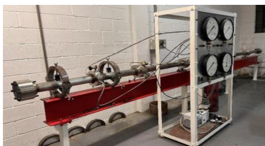
Figura 5. Construção do túnel finalizada com painel de controle.
