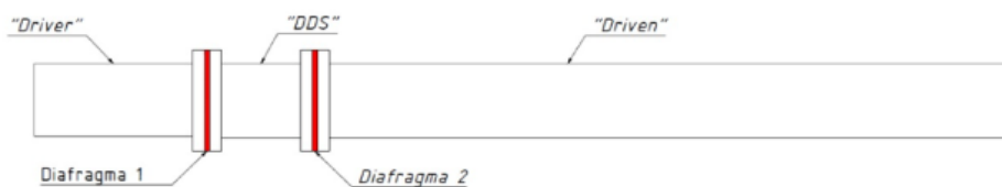
Figura 6 - Desenho esquemático e seções do túnel de choque
