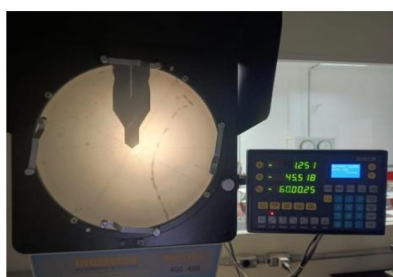
Figura 11. Controle dimensional da ferramenta de corte
