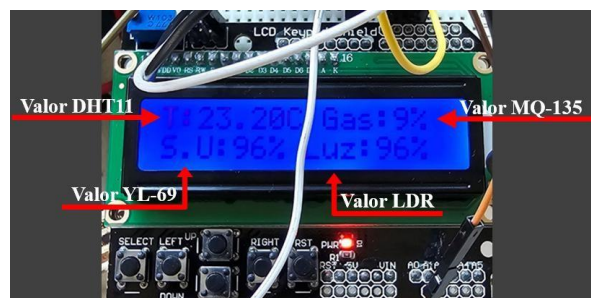
Figura 11 – Exibição dos valores dos sensores no display LCD.
