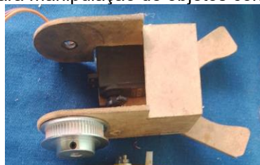
Figura 14 – Garra para manipulação de objetos confeccionada em MDF.
