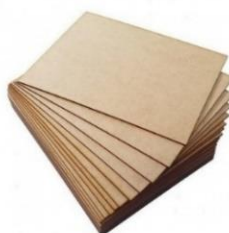
Figura 7 – MDF de 3 mm utilizado na construção da estrutura do braço articulado.
