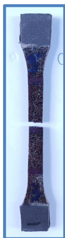
Figura 7– (a) fratura do corpo de prova do pó de café (b) fratura do corpo de prova do pó de café e juta (c) fratura do corpo de prova de pó de café e sisal
