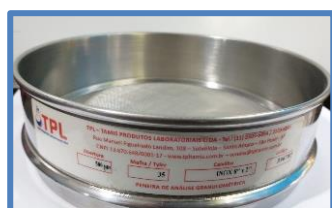
Figura 1 – (a) Peneira granulométrica com abertura de 500 \mu\text{m} (b) pó de café peneirado (c) tesoura e papel milimetrado
