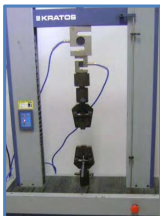
Figura 6 – (a) - Máquina de ensaio (b) Corpo de prova fixado
