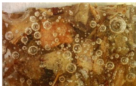
Figura 8- Superfícies dos corpos de prova e seção da falha (a) e (b) Alfazema (c) e (d) Orégano
