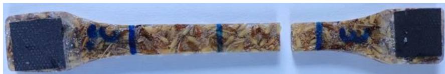
Figura 7 - Ilustração de corpo de prova pós-teste de tração
