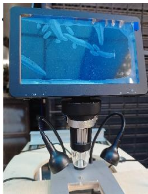
Figura 6 - Microscópio utilizado para avaliar a superfície da fratura do material
