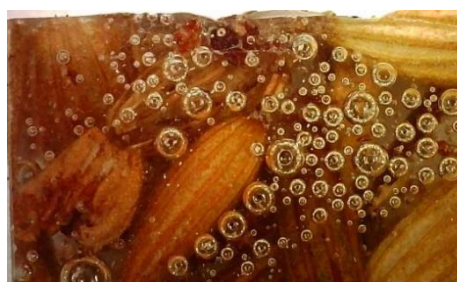
Figura 8- Superfícies dos corpos de prova e seção da falha (a) e (b) Alfazema (c) e (d) Orégano
