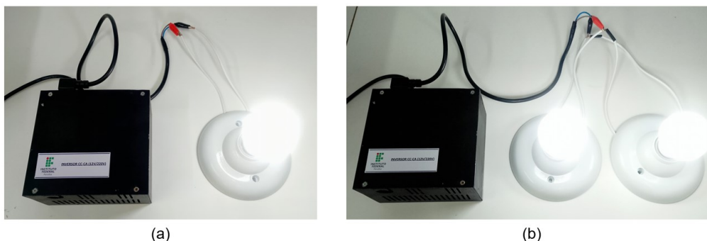
Figura 10 – (a) Teste prático do circuito considerando a inserção de uma lâmpada LED 9 W. (b) Teste prático do circuito considerando a inserção de duas lâmpadas LED 9 W ligadas em paralelo.
