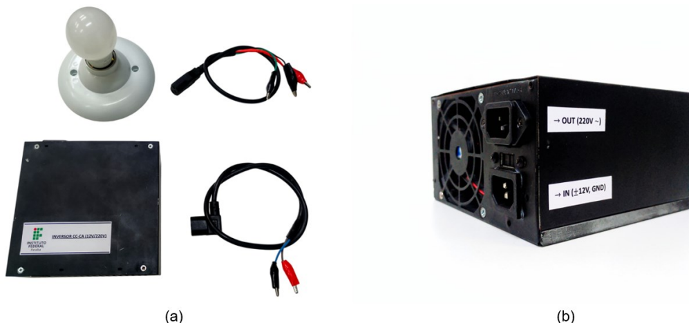
Figura 9 – (a) Projeto completo em vista superior. (b) Detalhe para alimentação de entrada e saída do módulo.
