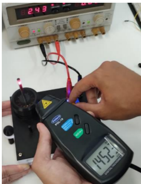
Figura 4 – Medição das Rotações por Minuto (RPM) do Motor.
