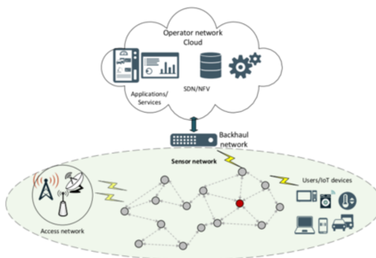
Figura 2 – Sistema de monitorização inteligente baseado na IoT, em que o nó vermelho indica o sensor avariado.
