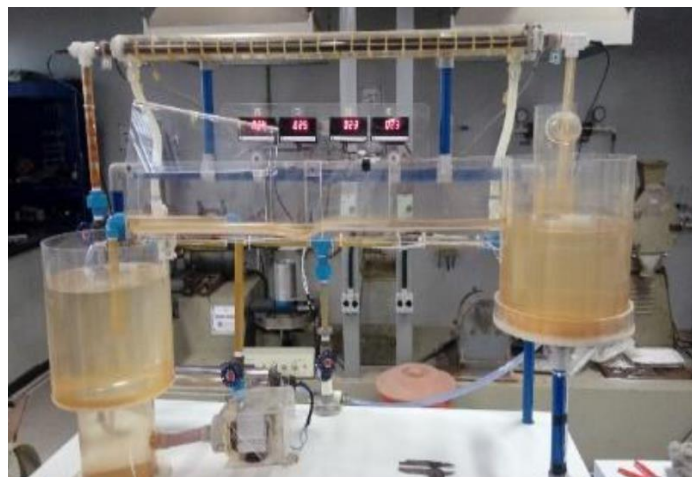
Figura 5 – Bancada experimental do trocador de calor do Laboratório de Operações Unitárias.
