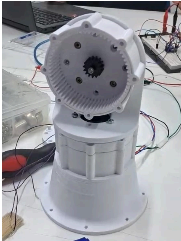
Figura 2 – Foto do manipulador confeccionado com a base e uma caixa de redução aberta.
