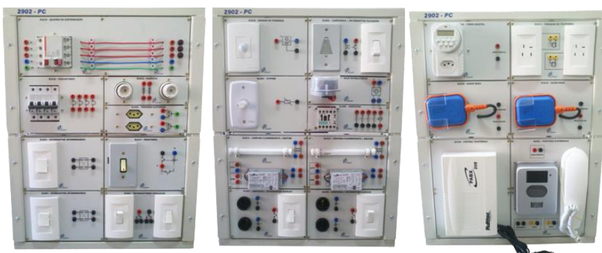
Figura 3: Painel de instalações elétricas prediais 2902PC.
