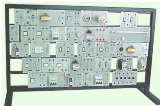
Figura 2: Kit Didático de Instalações Residenciais e Prediais.
