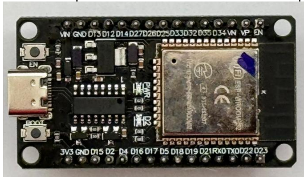
Figura 3 – Microprocessador utilizado – ESP32 de 30 pinos
