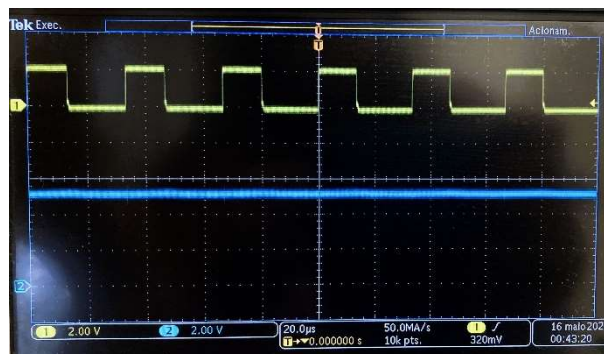
Figura 3 – Tela de resultados demonstrando o chaveamento do PWM (canal 1 em amarelo) e a tensão de saída (canal 2 em azul).
