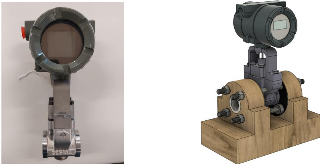
Figura 3 - Medidor Vórtex; (a) Fotografia, (b) Modelo 3D
