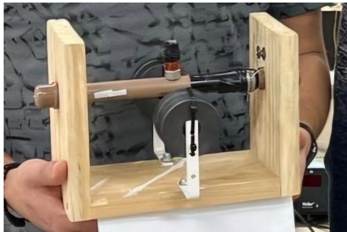
Figura 6 – Motor de Corrente Contínua Finalizado.
