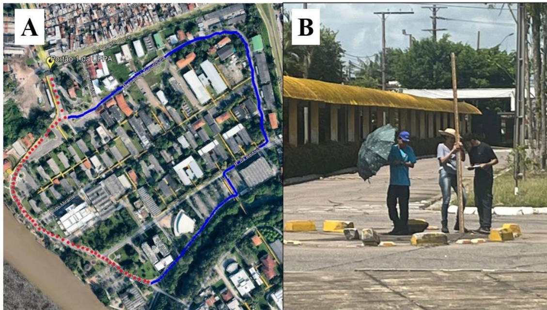
A – Trajetos do levantamento realizado no Campus Básico da UFPA com o PET de Engenharia Sanitária e Ambiental. B – Alunos do PET posicionando a mira graduada para a leitura do ponto.
