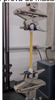
Figura 2b – Ensaio de tração no corpo de prova de macarrão
