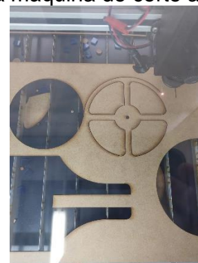
Figura 4b – Fabricação do carrinho em uma máquina de corte a laser
