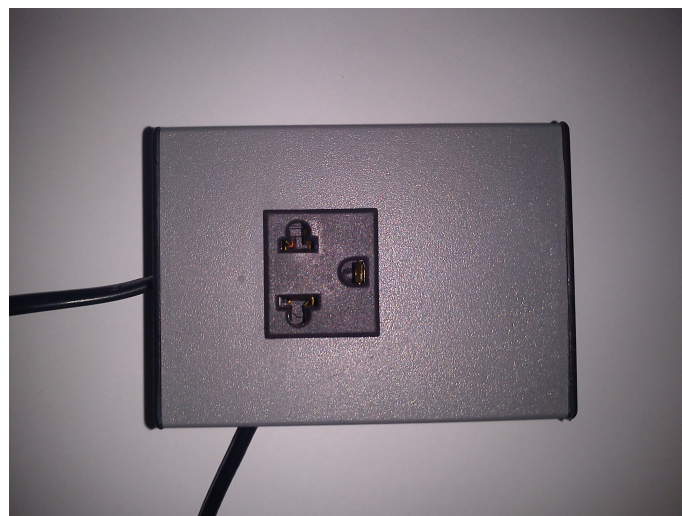
Figura 2 - Módulo de Alimentação e Chaveamento (MAC).
