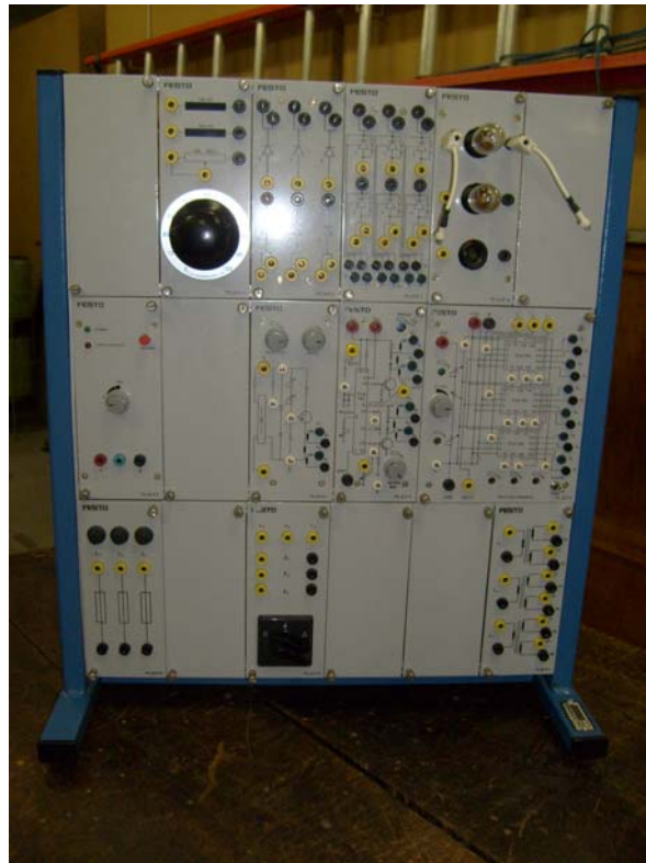
Figura 1 – Kit didático do Sistema S para o ensino de Eletrônica de Potência.
