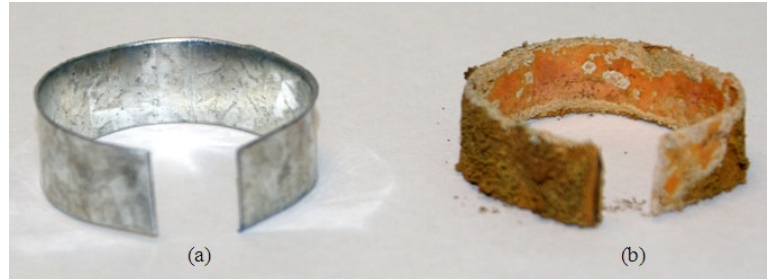
Figura 1 – C-d-p antes a) e após b) o ensaio de corrosão.
