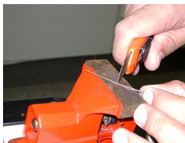
Fig. 3—Ranhuras sendo feitas na agulha.
