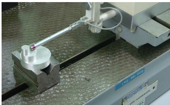
Figura 11 – Medição da rugosidade da peça
